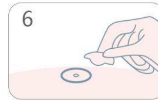
6 除去剥离纸，将胶布压好以确保粘附稳妥
